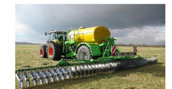
Рис. 2.32 - Агрегат для внесения КАС и ЖКУ при междурядной обработке
