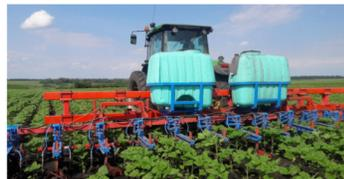
Рис. 2.31 - Агрегат для внесения КАС и ЖКУ
